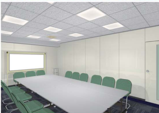
LED照明と放射空調用パネルを組み合わせた設置イメージ (株)オクジャー提供
