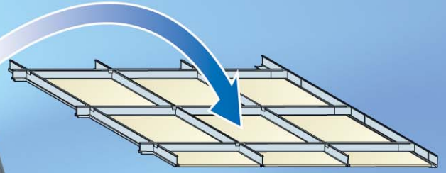
600グリッドシステム天井
